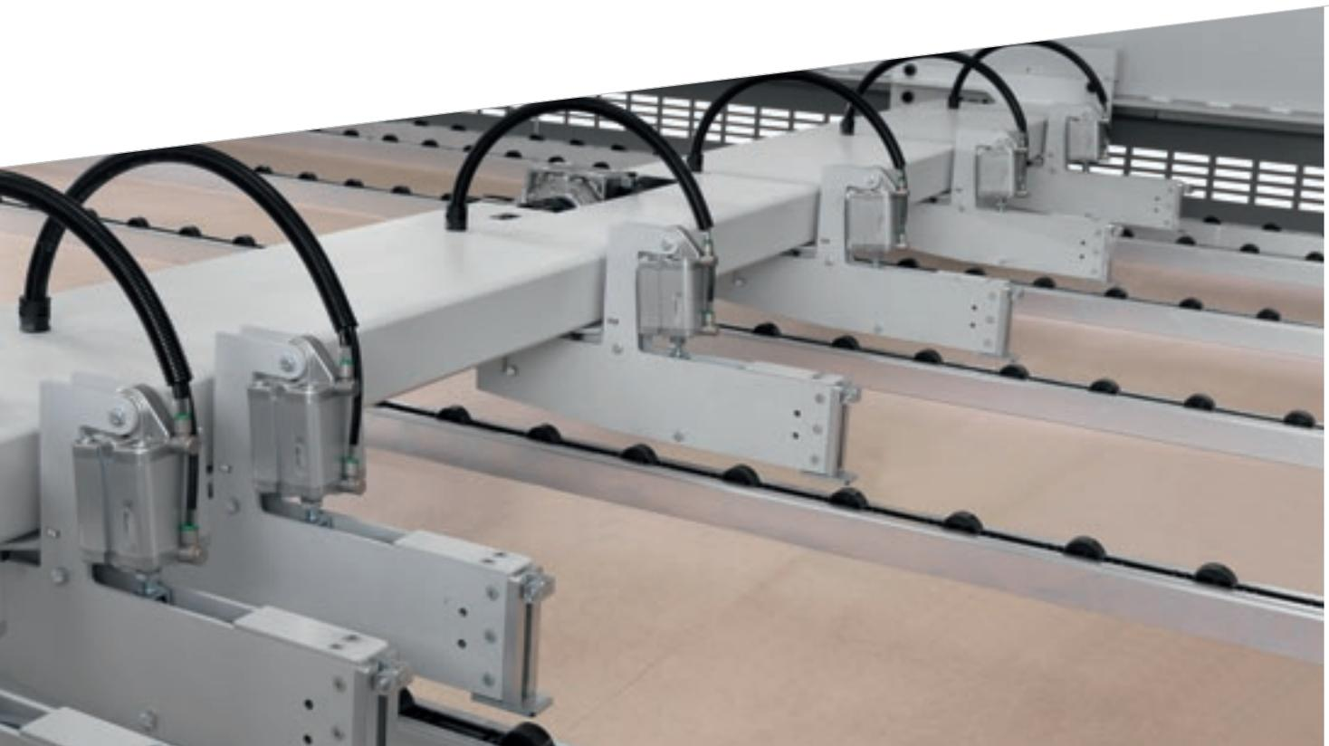
Les pincers, indépendantes et autonivellantes, assurent une prise solide des panneaux et l'éjection complète des piles coupées hors de la ligne de sciage.
