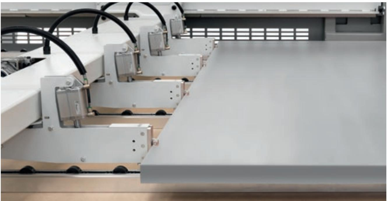
Positionnement précis et rapide des panneaux pour un maximum de précision de coupe grâce au chariot pousseur très robuste actionné par un moteur brushless. Le plan de guidage sous le pousseur est équipé de roues libres et indépendantes afin d'éviter de rayer les panneaux aux surfaces délicates.
